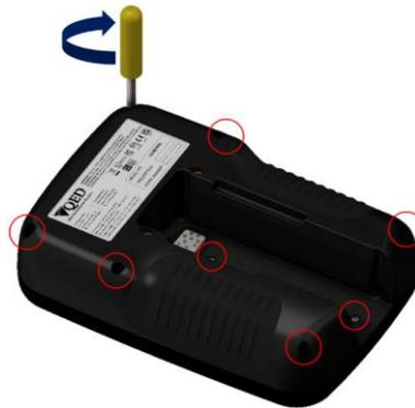
Figure 18 – Ajustement du boîtier arrière
